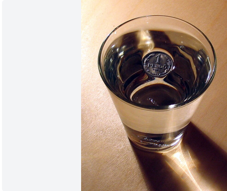
Oberflächenspannung von Wasser – eine messbare physikalische Stoffeigenschaft. Bild von Roger McLassus, Source
